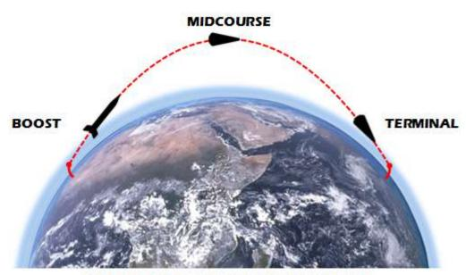
PHASES OF BALLISTIC MISSILE FLIGHT
